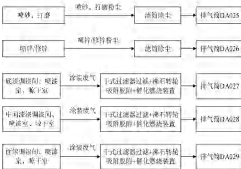
图 7.2-2 涂装废气处理工艺流程
